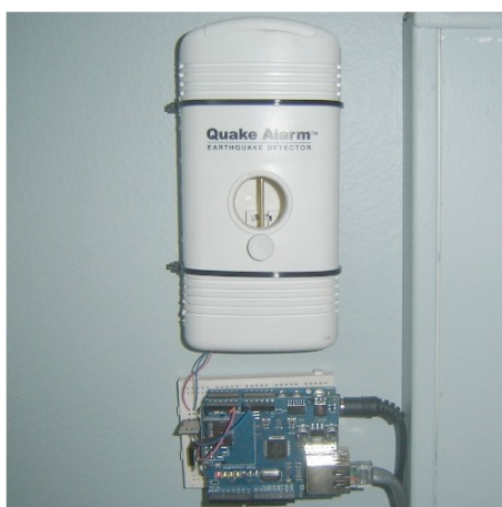
Figura 6: Alarma Sismos (HEIM, 2011)
