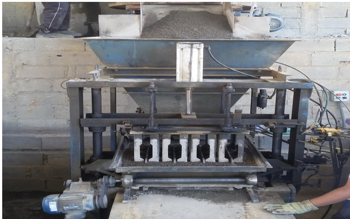
Figura 12 Máquina pneumática utilizada na fabricação
