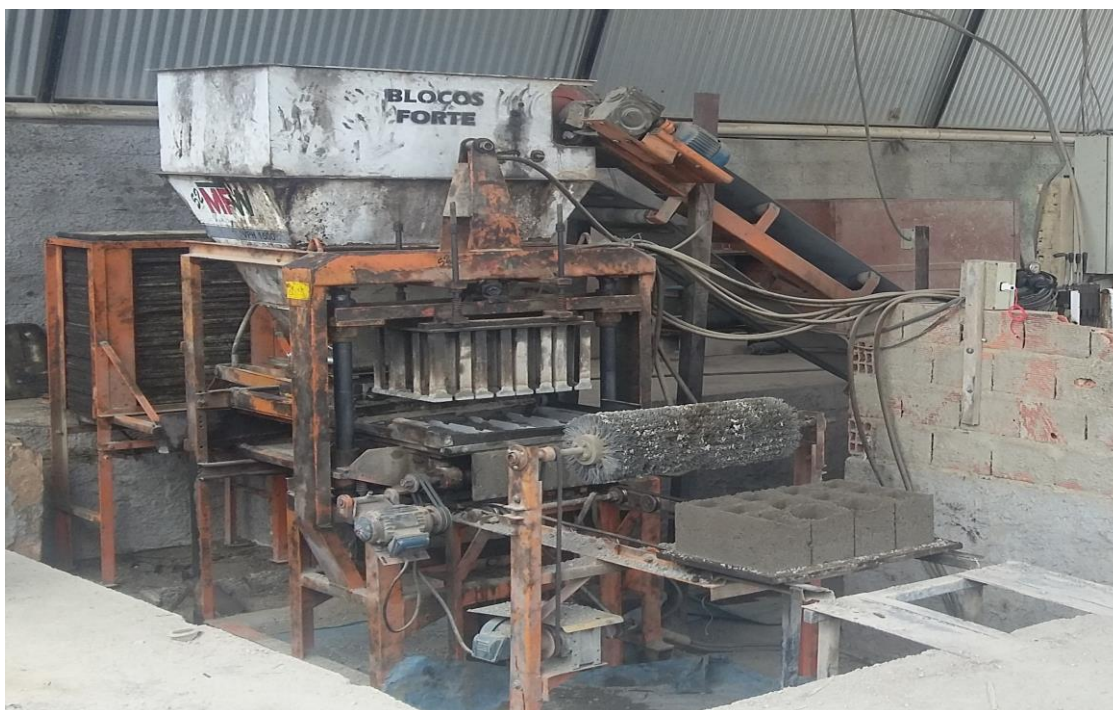
Figura 8 Maquinário utilizado na fabricação dos blocos
