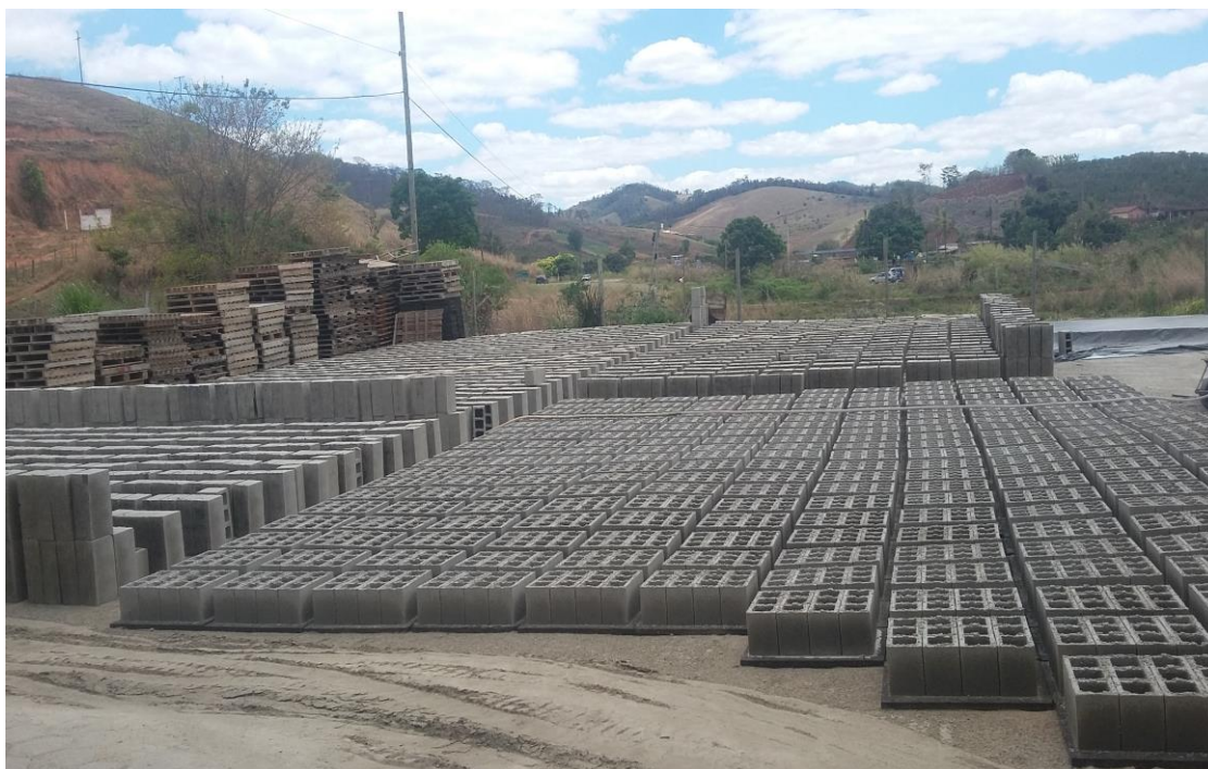
Figura 6 Produção diária de blocos de concreto
