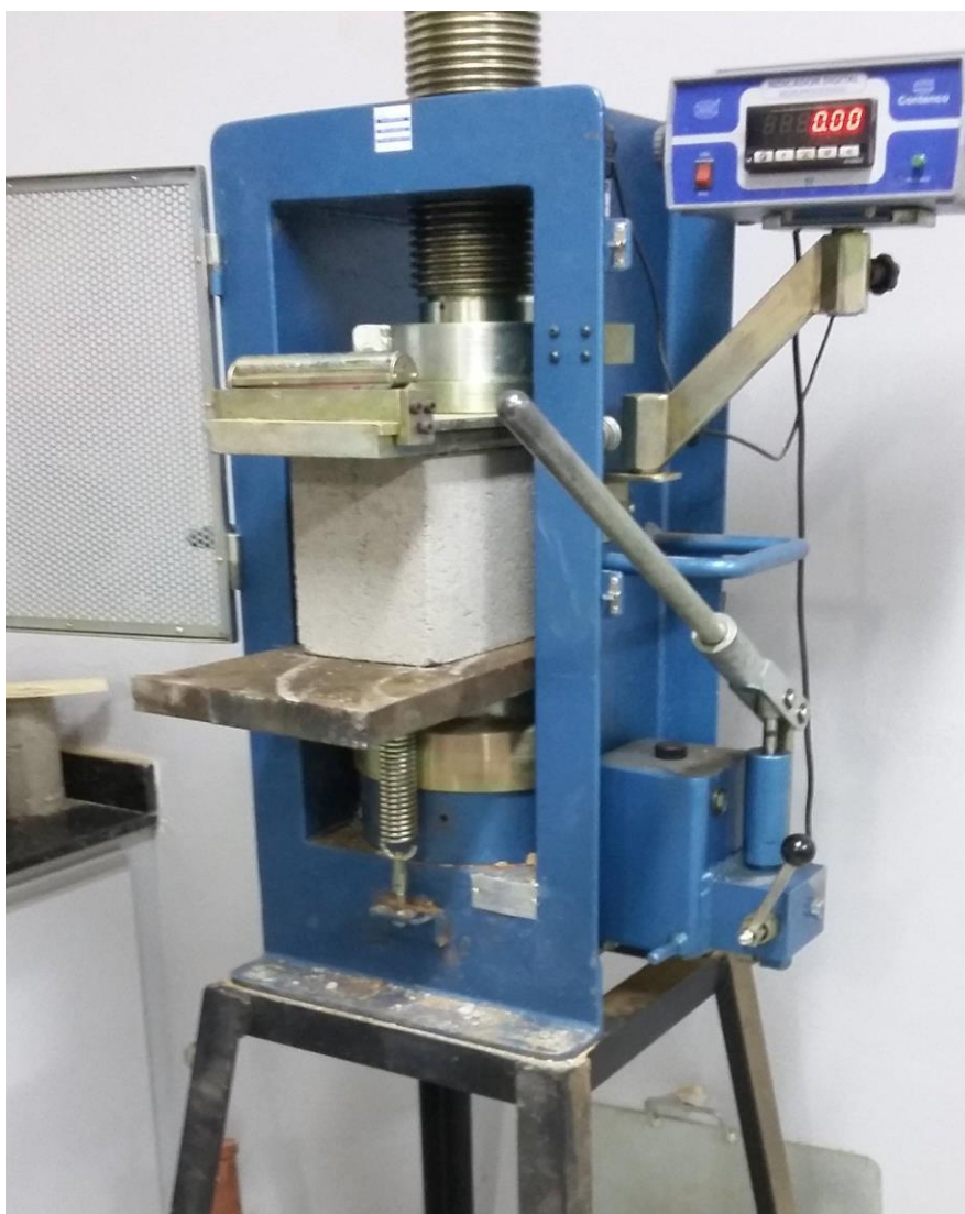
Figura 18 Ensaio de resistência à compressão
