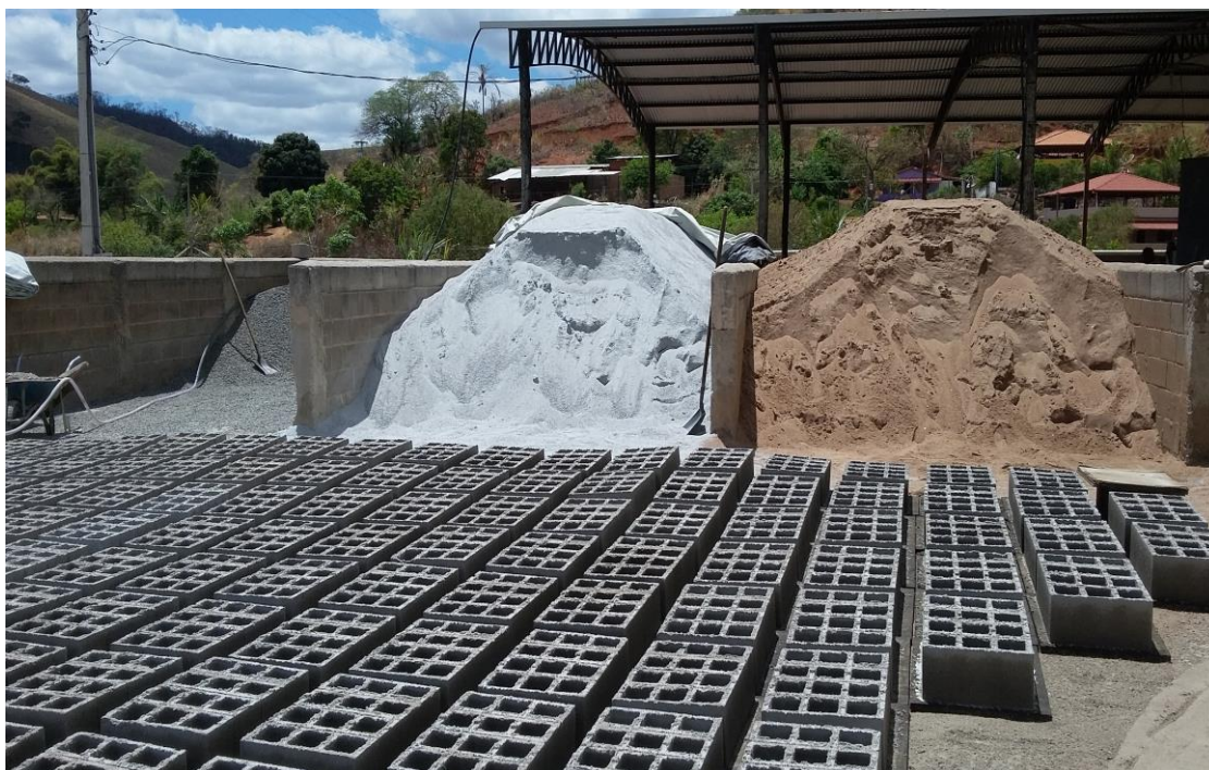
Figura 7 Materiais utilizados para a fabricação dos blocos
