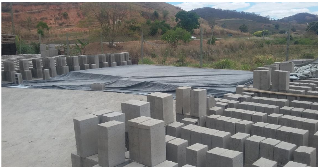
Figura 10 Método de cura utilizado
