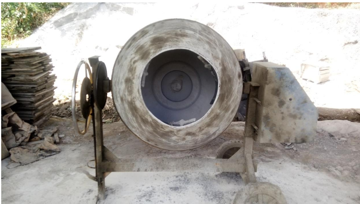
Figura 5 Máquina para mistura de insumos
