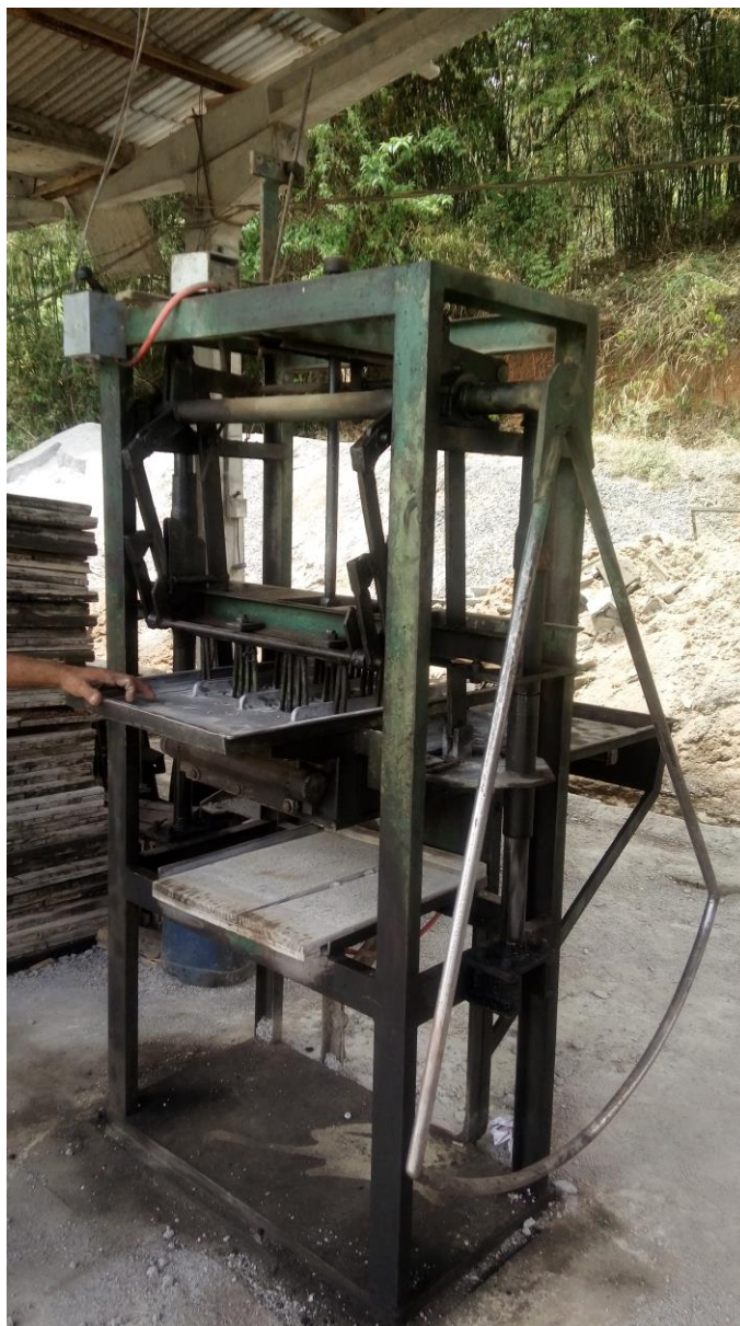
Figura 4 Máquina manual para fabricação
