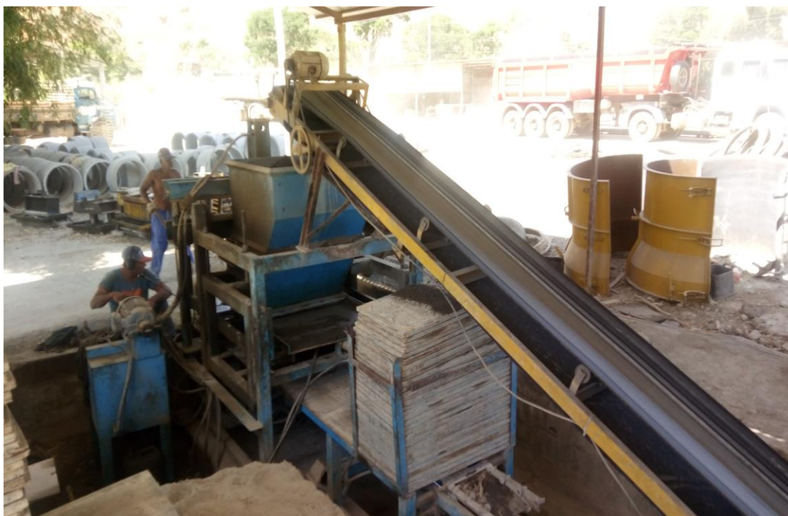
Figura 15 Máquina hidráulica para fabricação dos blocos
