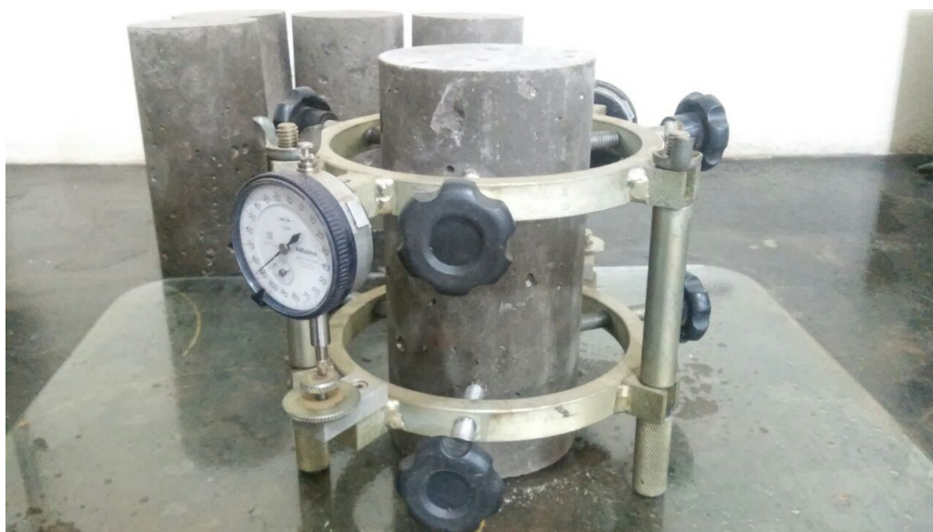
Figura 35: Preparação do corpo de prova para execução do ensaio de determinação do módulo estático de elasticidade.
