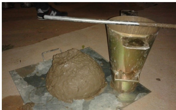
Figura 30: Abatimento de 140 mm do concreto convencional.
