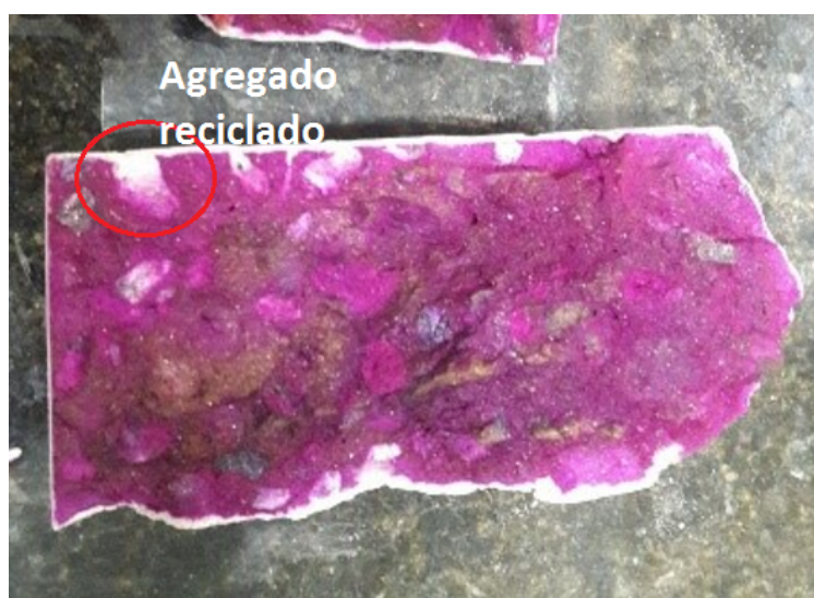
Figura 46: Profundidade de carbonatação no concreto reciclado.
