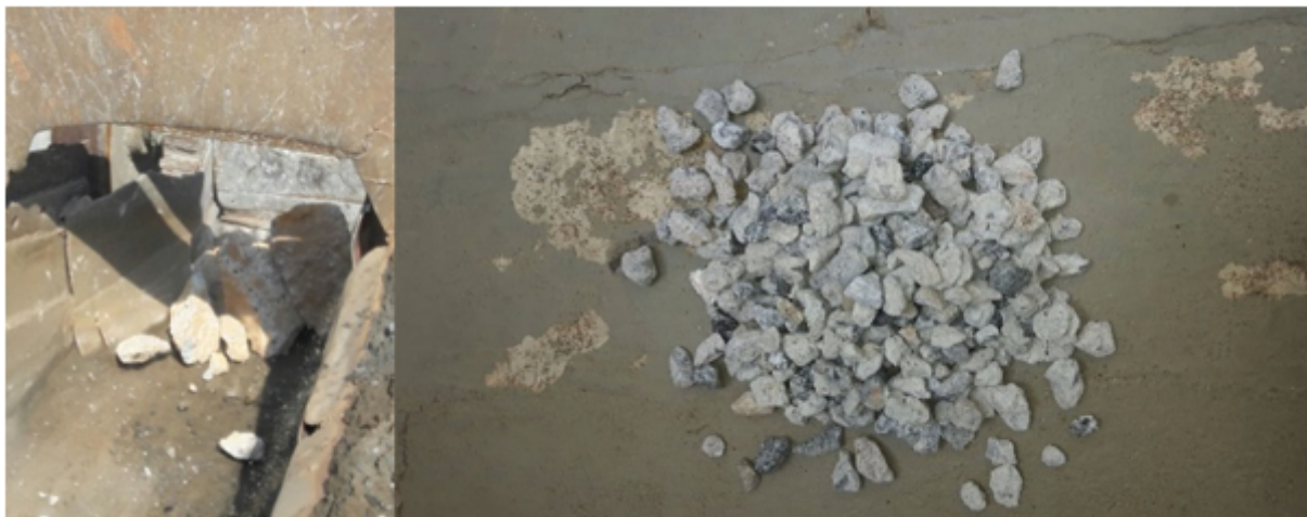
Figura 21: Processo de britagem – à esquerda contrapiso no britador e à direita o agregado reciclado.
