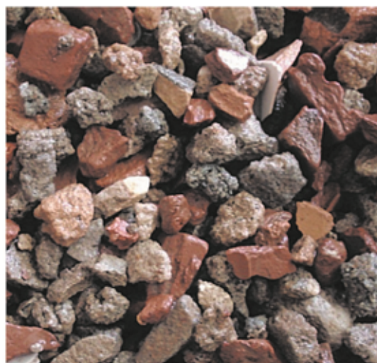
Figura 17: Agregados reciclados: agregado de RCD misto.
