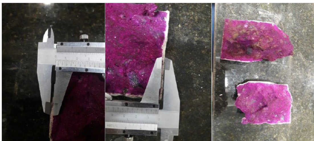
Figura 37: Verificação da carbonatação no concreto convencional.
