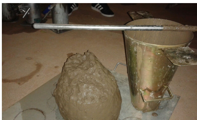
Figura 31: Abatimento de 120 mm do concreto reciclado.
