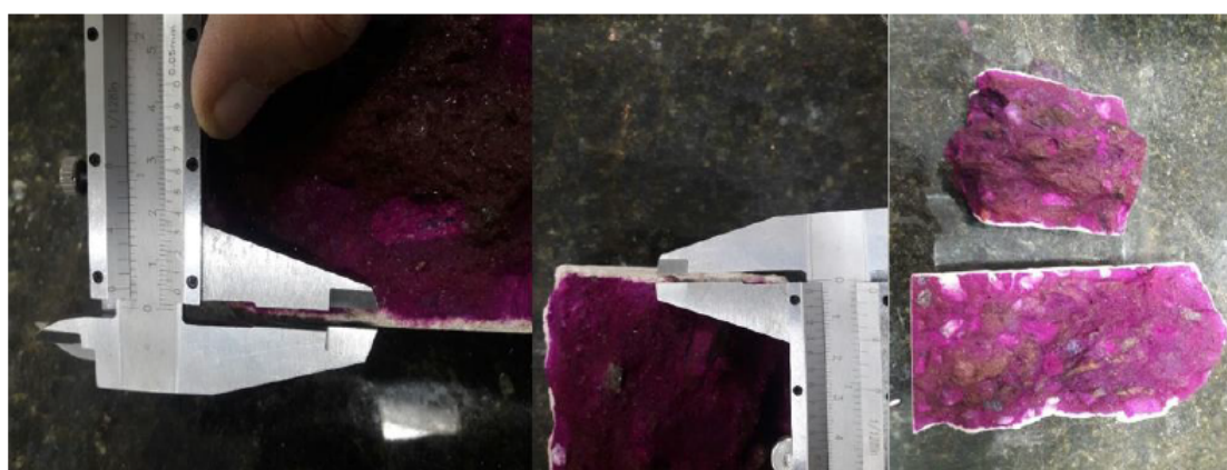
Figura 38: Verificação da carbonatação no concreto com RCD.
