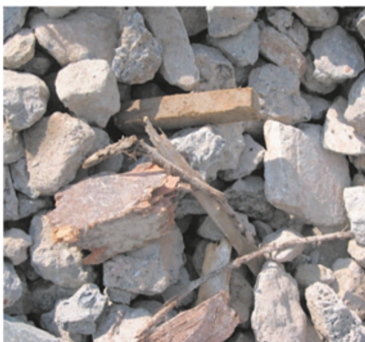
Figura 16: Agregados reciclados: agregado de concreto reciclado, ainda misturado com impurezas
