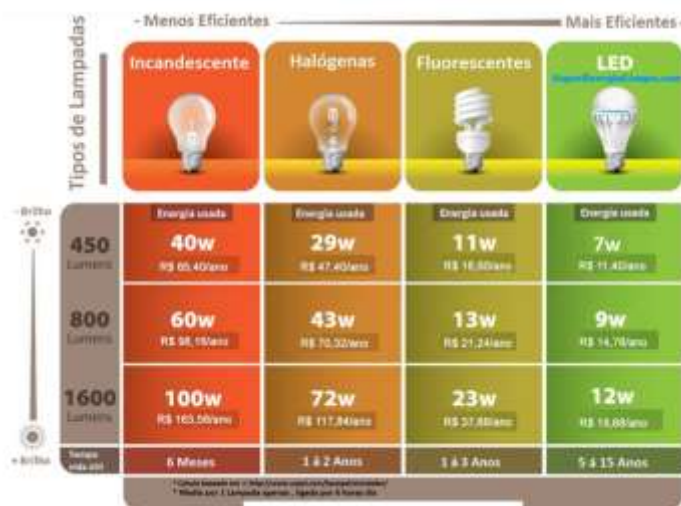
Figura 8 – Comparativo de Eficiência entre Tipos de Lâmpadas
