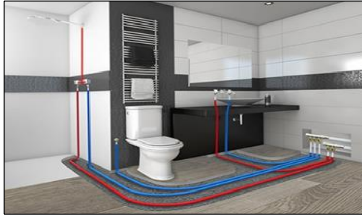
Figura 38 - Instalação de água fria e quente em PEX
