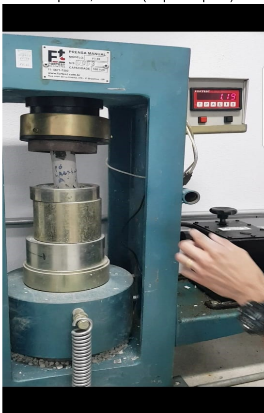
Exemplar 0,001% A (Ruptura tipo D)
