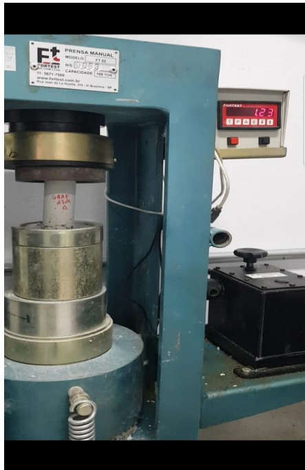
Exemplar 0,001% A (Ruptura tipo D)
