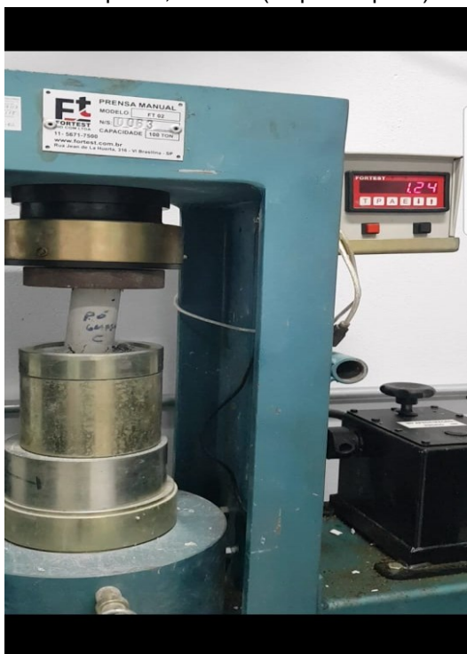
Exemplar 0,001% C (Ruptura tipo C)
