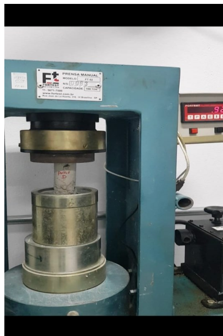
Exemplar 0D (Ruptura tipo C)
