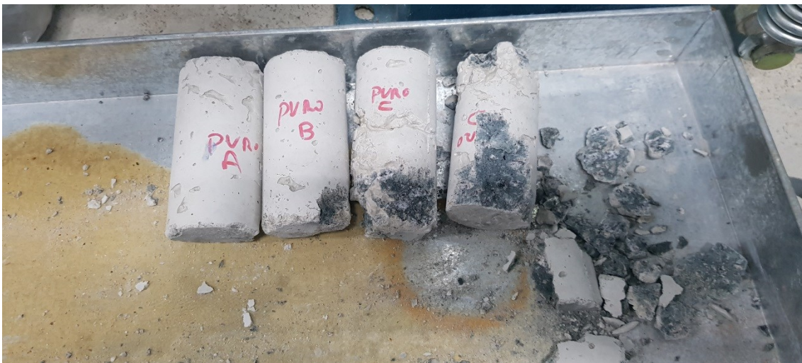
Figura 21 - Corpos de prova após ruptura na idade de 14 dias
