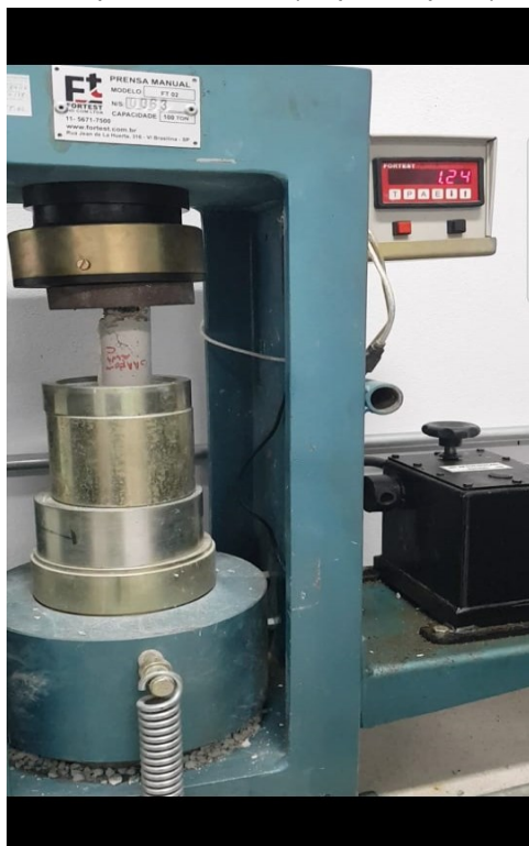
Exemplar 0,001% C (Ruptura tipo D)
