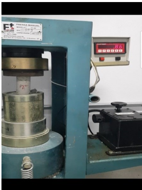
Exemplar 0A (Ruptura tipo C)
