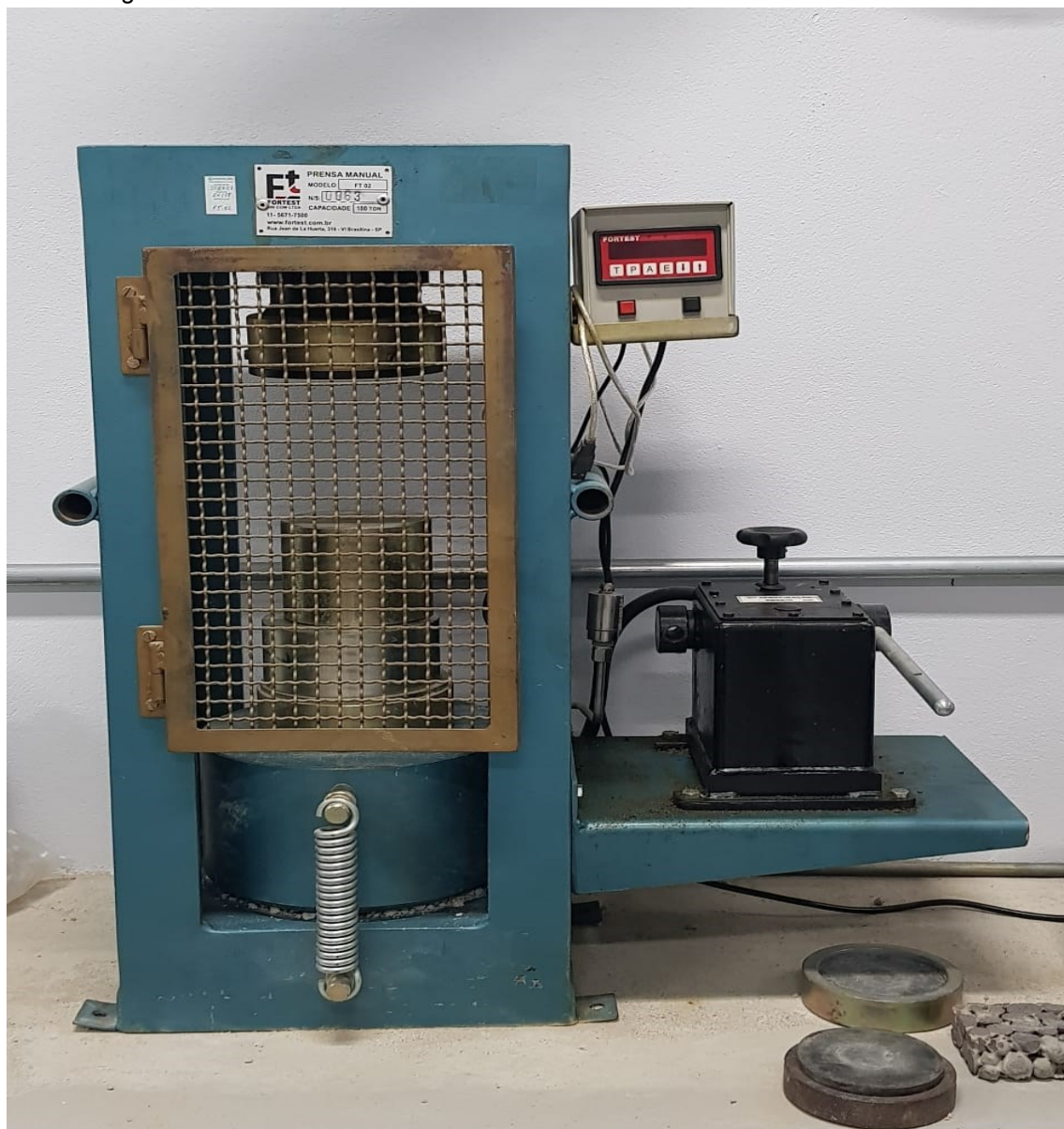
Figura 17 - Prensa manual da Marca Fortest modelo FT02 utilizada no teste
