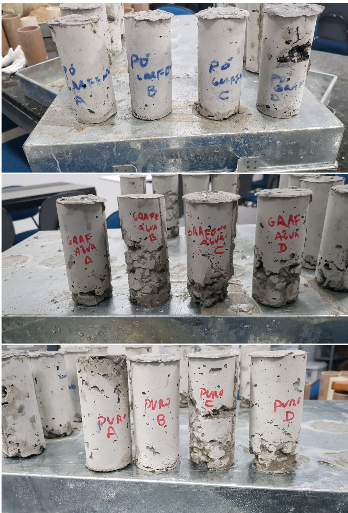
Figura 16 – Representação dos 12 corpos de prova desmoldados
