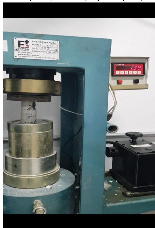
Exemplar 0,001% D (Ruptura tipo D)
