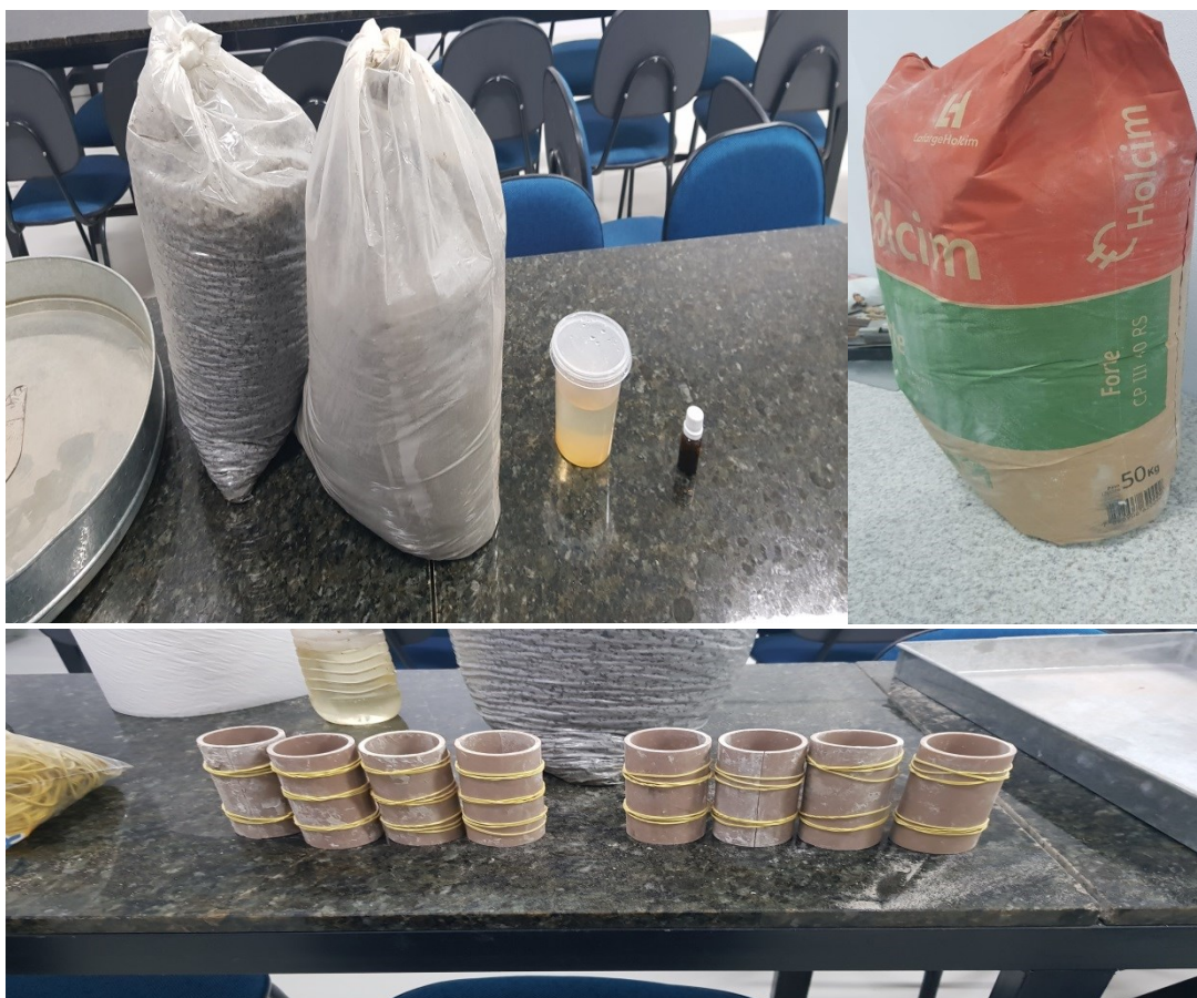
Figura 11 - Materiais utilizados na preparação dos corpos de prova
