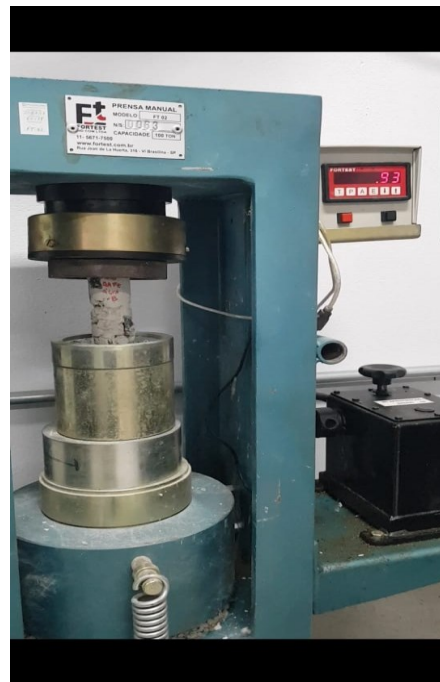
Exemplar 0,001% B (Ruptura tipo D)
