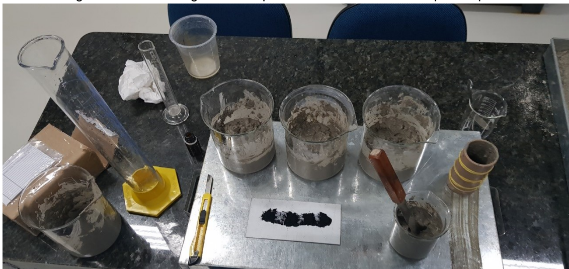
Figura 13 - Óxido de grafeno em pó sendo adicionado nos corpos de prova
