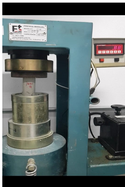
Exemplar 0B (Ruptura tipo D)
