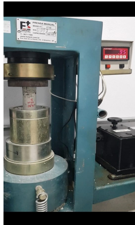
Exemplar 0,001% D (Ruptura tipo D)
