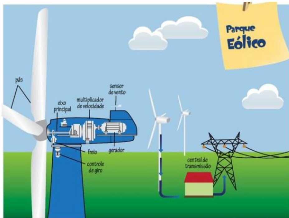
Figura 4 – Imagem ilustrativa do funcionamento de um parque eólico.
