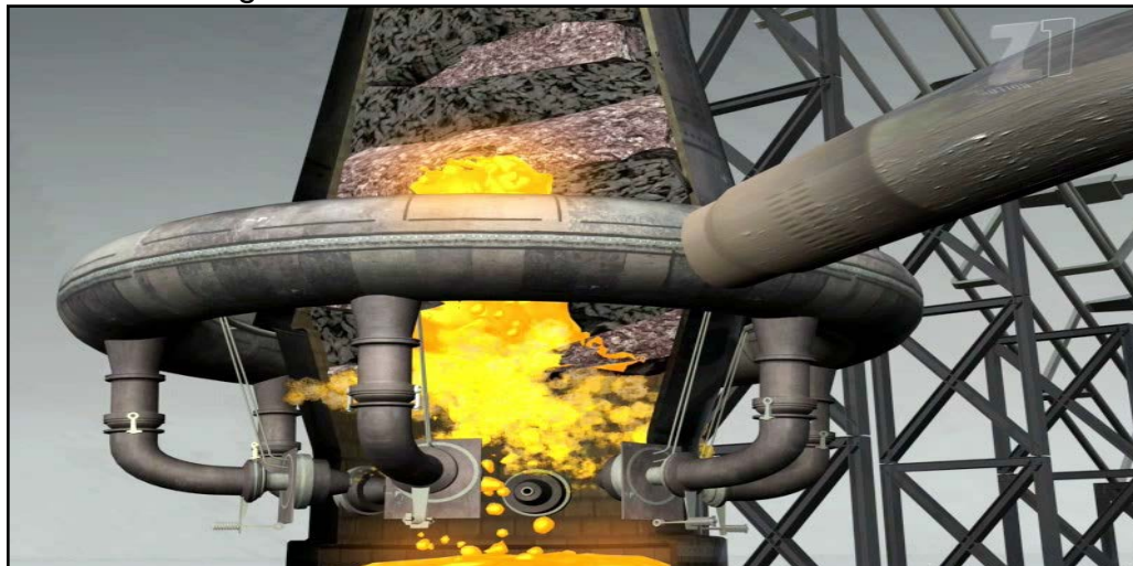
Figura 6 - Sistema de ventaneiras no alto forno
