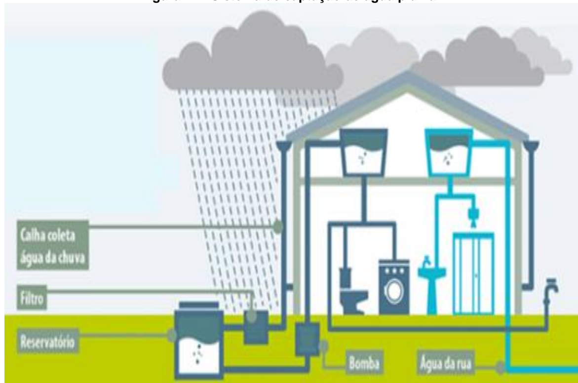
Figura 2.1: Sistema de captação de água pluvial.
