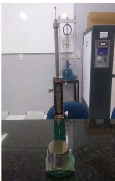
Figura 13: Execução do teste de Vicat
