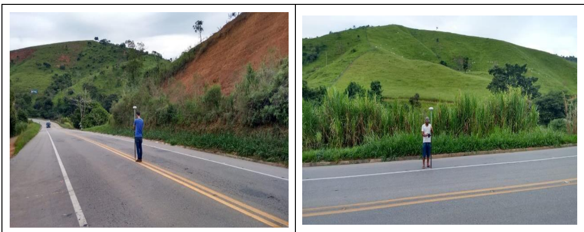
Figura 26 - Coleta de coordenadas no eixo (a) e Coleta de coordenadas na faixa de acostamento (b)
