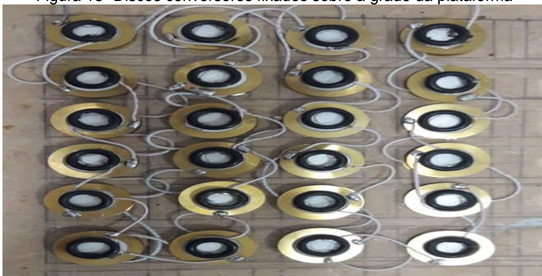
Figura 13- Discos conversores fixados sobre a grade da plataforma
