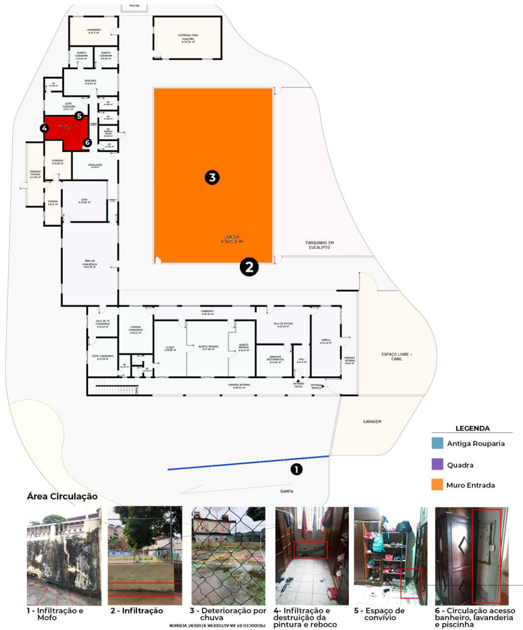
Figura 45 - Pontos críticos das patologias
