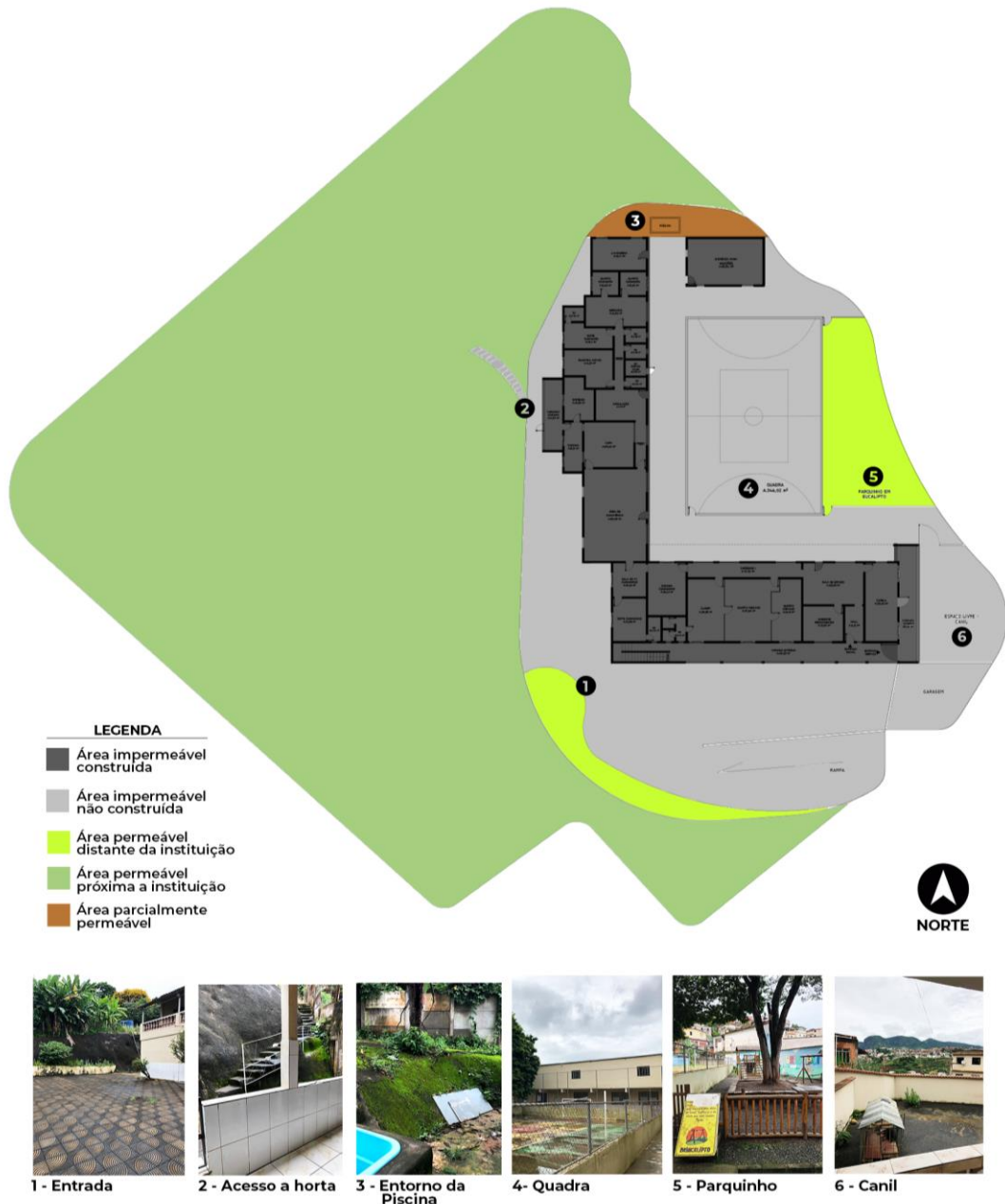
Figura 34 - Áreas permeáveis e impermeáveis no lote de localização do Lar das Meninas
