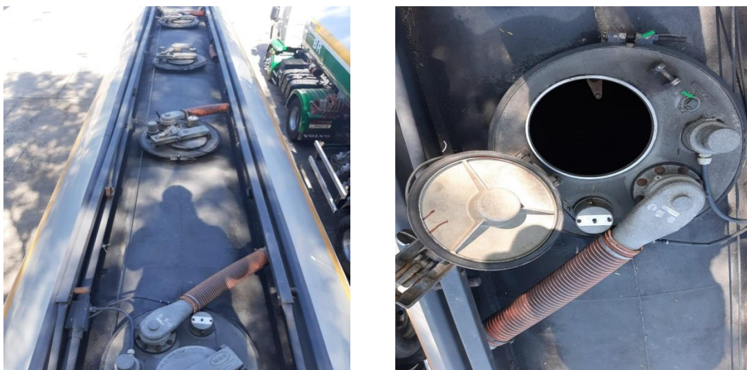
Figura 10: Foto Boca de Visita Carreta Tanque. Arquivo COPETRANS (2014)
