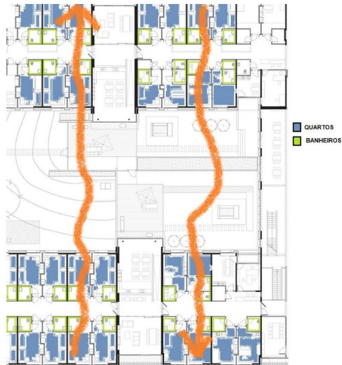
Figura 29 – Planta Baixa simplificada Centro Psiquiátrico Friedrichshafen, com esquema de ventilação e iluminação.
