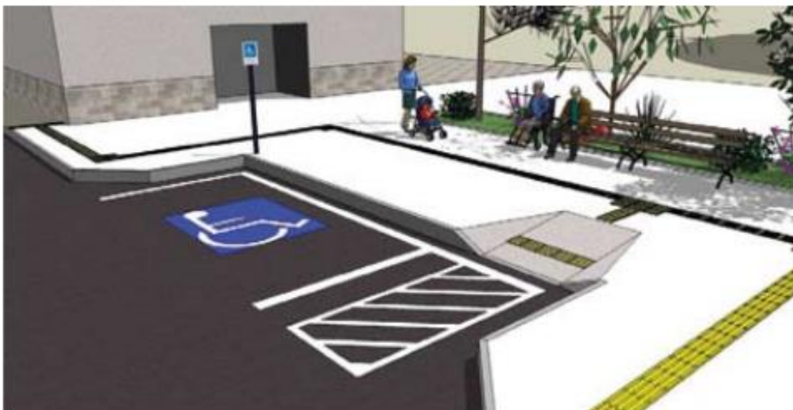
Figura 63: Imagem ilustrativa de rebaixamento de calçada para acessibilidade.
