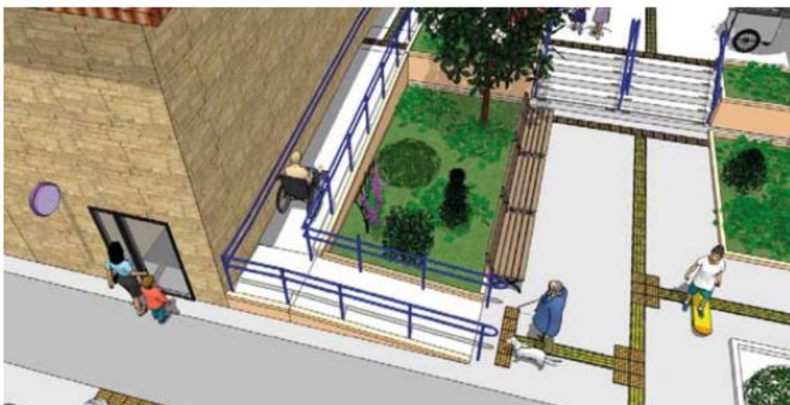
Figura 64: Imagem ilustrativa de rampa de acessibilidade e pisos podotatés.
