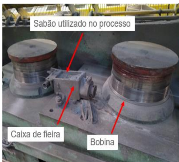
Figura 4: processo de redução de fio máquina por fieiras
