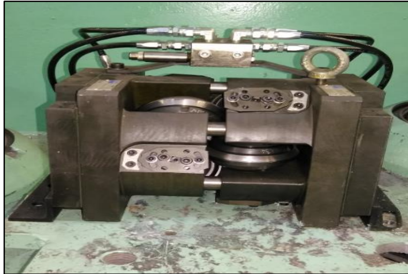
Figura 8: Representa o laminador microcassete
