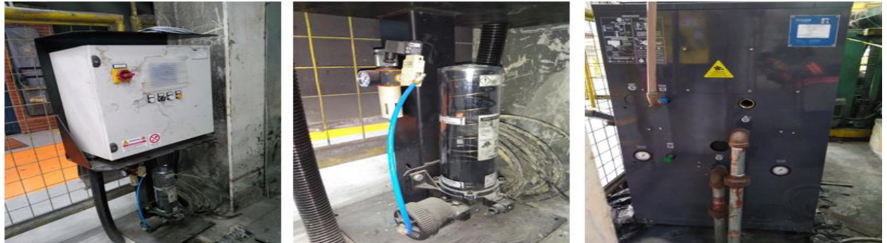
Figura 11: Mostra painel e bomba para lubrificação automática e o chiler para refrigeração dos microcassetes.
