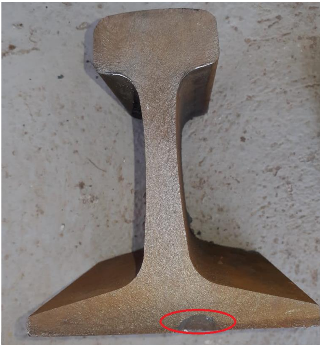
Figura 04: Início da Fratura Fonte: Autores (2020)
