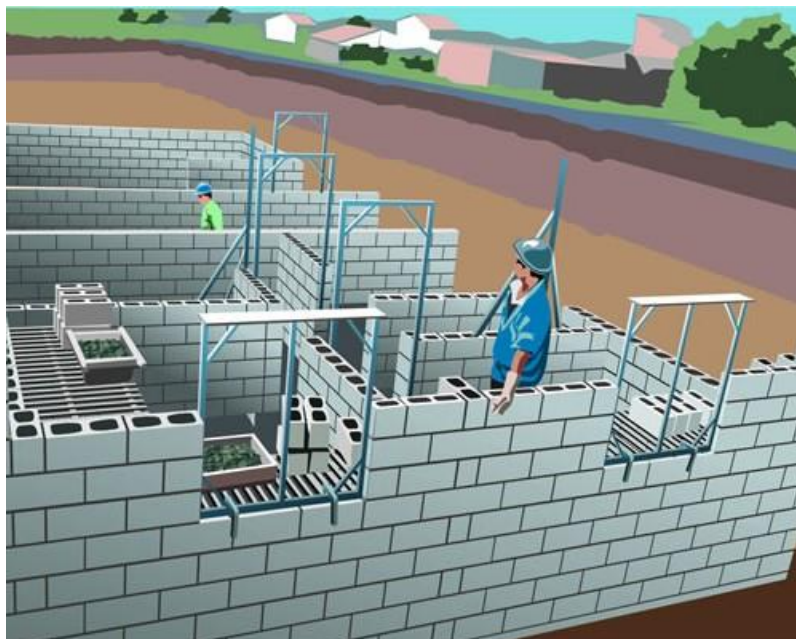
Figura 1 Alvenaria estrutural bloco de concreto.
