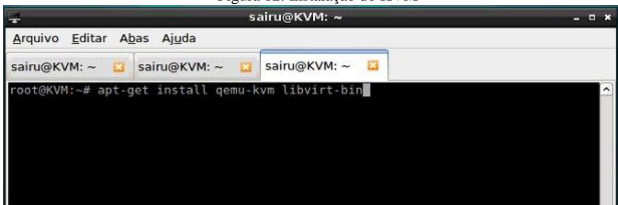
Figura 12: Instalação do KVM
