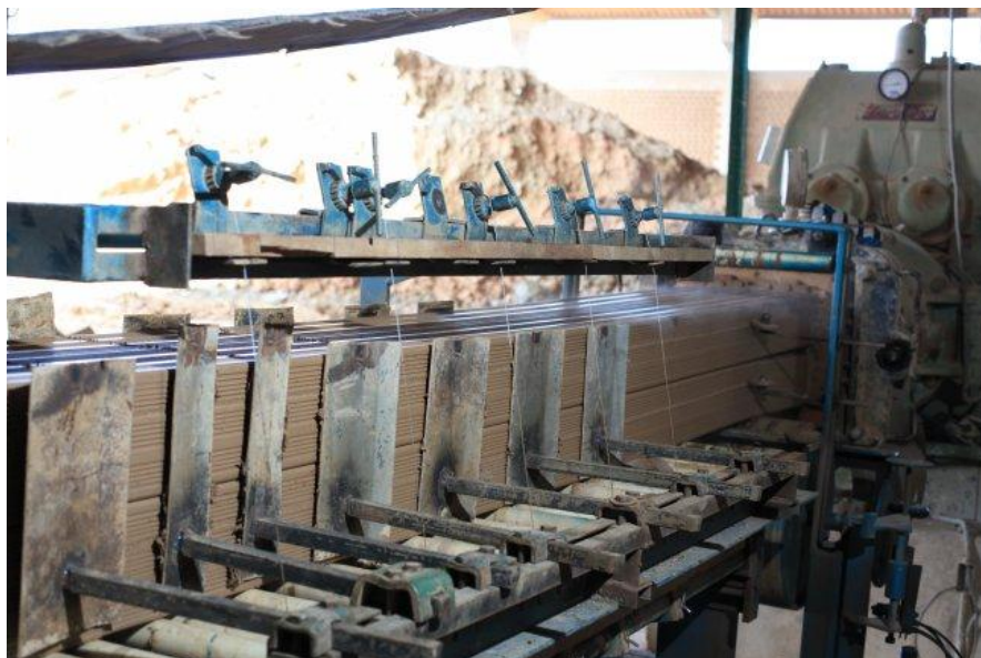
Figura 5: Etapa de conformação do tijolo em máquinas extrusoras
