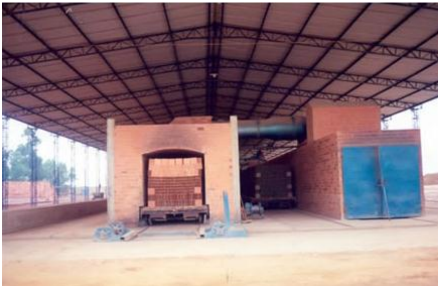
Figura 6- Tijolos cerâmicos sendo colocados em fornos para queima
