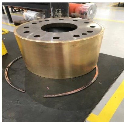
Figura 9: Usinagem do êmbolo para preenchimento de solda
