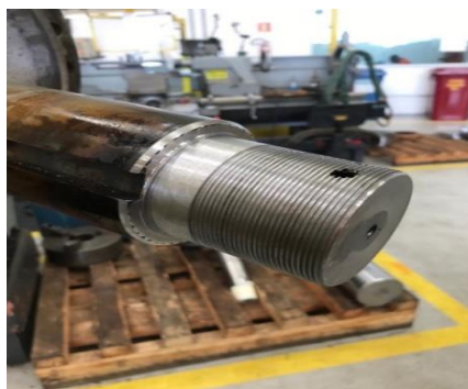
Figura 8: Usinagem de acabamento da ponteira do cabeçote
