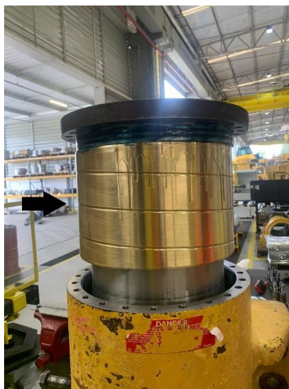
Figura 11: Usinagem final do êmbolo
