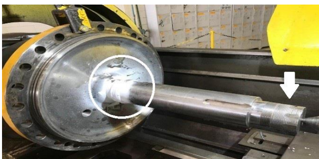
Figura 6: Cabeçote com a ponteira da rosca danificada
