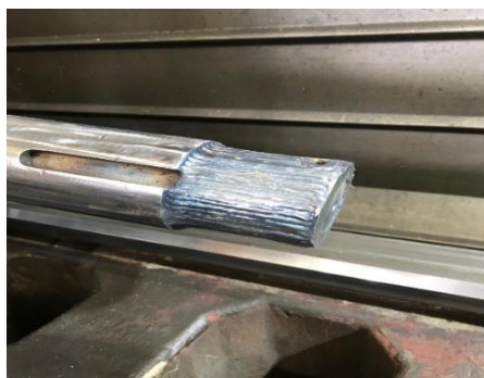
Figura 7: Aplicação da solda
